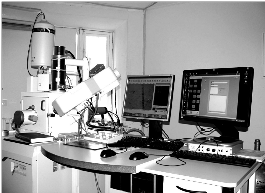
Рис. 4. Сканирующий электронный микроскоп (СЭМ), модель “JSM-6490”. Лаборатория физических методов исследования ИГН НАН Украины
