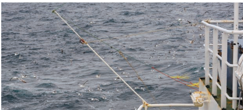
Рис. 11. Стационарный вынос для крепления стримерной линии на корме судна
