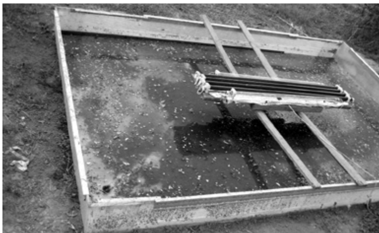
Рисунок 64. «Мокрая ловушка» для ночных насекомых в Сальском районе Ростовской области, 2014 г. Блок УФ-ламп «тёмного света» расположен над ванной с водой (автор устройства А.М. Медведев).
