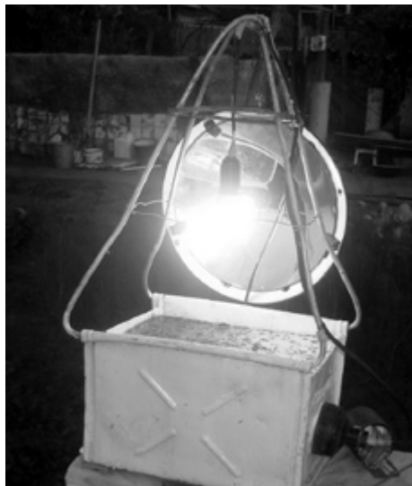
Рисунок 63. «Мокрая ловушка» для ночных насекомых в Усть-Донецком районе Ростовской области, 2015 г. Ртутная лампа с рефлектором-отражателем укреплена над ёмкостью с водой, другая лампа горит под водой (автор устройства агроном Ю.П. Шкоденко).
