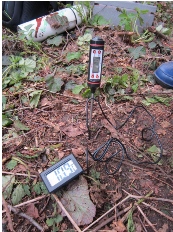
Рис. 2.3 Измерение температуры почвы электронным термометром ТЕ-113
