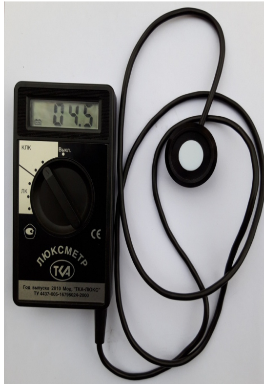
Рис. 2.2 Портативный люксметр ТКА-люкс
