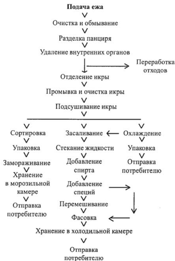
Рис. 7.3.1.3. Схема обобщенного техпроцесса переработки морского ежа (по: Ramachandran, Terushige, 1991)
