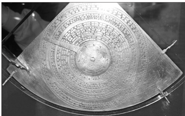
Астролябия (угломерный прибор для приблизительного определения широт и долгот в астрономии). 1325 г. Национальный музей авиации и космонавтики на Моллу, Вашингтон О.К. Фото В. Богатова
