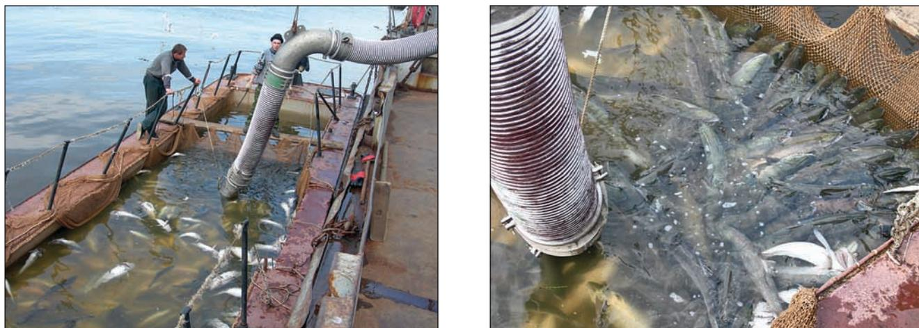
**Рис. 283.** Разгрузка рыбонасосом прорези с неркой, кетой, чавычей, треской и другими рыбами, доставленной катером со ставного морского невода – ООО «Устькамчатрыба» (30 июня 2006 г.)
