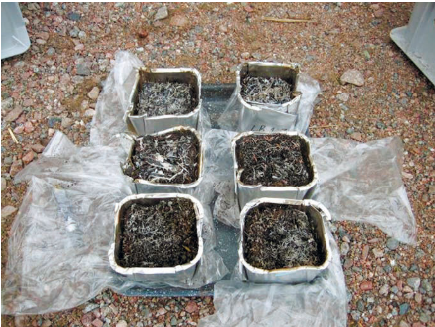
Рис. 8. Проведение эксперимента с выжиганием: (А) выжигание почвенной пробы в течение 1 минуты газовой горелкой, (Б) тлеющие пробы.
