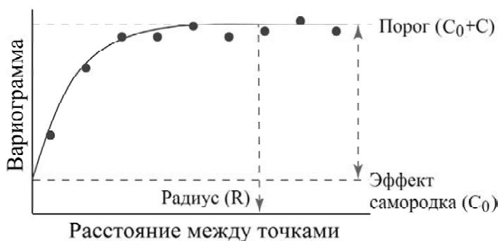
Рис. 47. Вариограмма (по: Ettema, Wardle, 2002, с изменениями). Исходное значение показателя в точке (0;0) отражает «эффект самородка». Приращение суммарной вариации (по оси Y ) при удалении от исходной точки (по оси X ) показывает автокорреляцию. Когда вариограмма достигает порога, соответствующее расстояние от точки (0;0) выявляет радиус пятна автокорреляции. Точками обозначены экспериментально полученные значения, а кривой – модель, описывающая их распределение.
