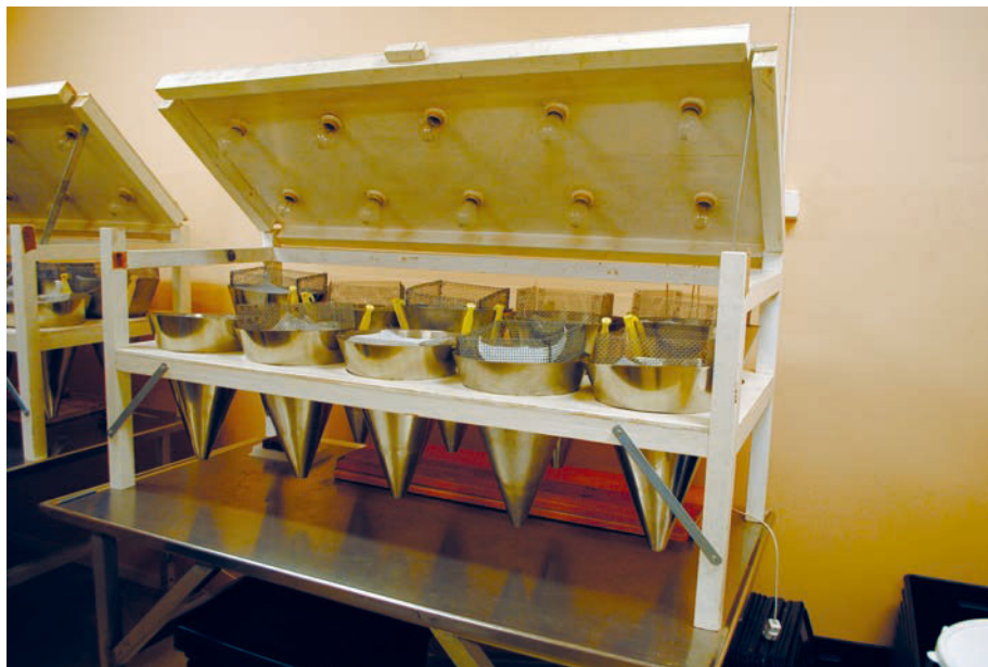
Рис. 2. Экстрактор Туллгрена в модификации ван Страалена – Райнинкса, используемый в Департаменте экологии Шведского университета сельскохозяйственных наук (г. Уппсала).
