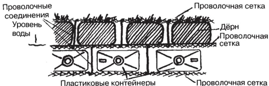
Рис. 8. Устройство плавучих плотов для гнездования гагар (по: Merrie, 1979).
