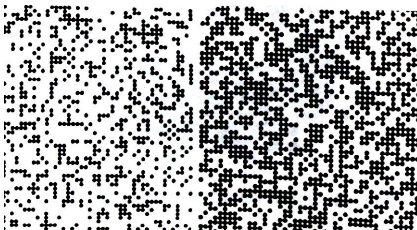
Рис. 46. Узлы решетки ниже порога перколяции (слева) и вблизи него (Шредер, 2001)
