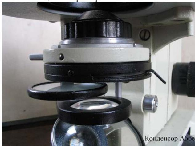
**Конденсор** состоит из **нескольких линз**, вмонтированных в металлическую оправу, закрепляемую особым винтом в гильзе держателя. По существу **конденсор** представляет **светосильный, короткофокусный объектив** (в ряде случаев вместо конденсора используют объектив такой же апертуры, как и объектив, с которым ведется наблюдение, зажимая его в особое центрируемое приспособление, которое вставляют в гильзу конденсодержателя). Чем **светосильнее** конденсор, тем большее число линз он содержит.
