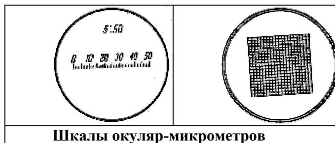
Для проведения измерений препарат помещают на предметный столик. Изображение объекта совмещают со шкалой окуляр-микрометра и определяют скольким делениям соответствует его длина. Зная цену деления окуляр-микрометра (при данной комбинации объектива и окуляра!), определяют длину объекта, умножая количество делений на цену деления.
