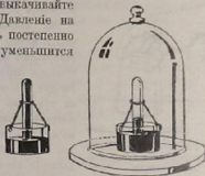
Рис. 48. Ртуть удерживается в пробирке атмосферным давлением и опускается, когда окружающий воздух удаляется.
