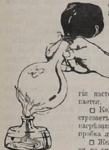
Рис. 30. При нагревании воздуха в колбе расширяется и раздувает шар.
