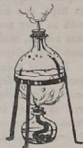
Рис. 22. При нагреваніи вода кипитъ и обращается въ паръ. Въ верхней части сосуда паръ сгущается въ жидкія капли.
