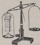
Рис. 45. Чашка, на которой стоитъ сгорающая свѣча, перевѣшивается.
