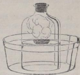
Рис. 36. При горѣніи фосфора подъ колпакомъ уровень воды поднимается.
