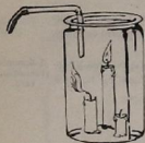
Рис. 17. Углекислый газ, вливаясь в банку, поочередно гасит свечи, начиная с нижней.
