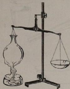
Рис. 9. При нагреваніи колбы часть воздуха выходитъ и колба дѣлается легче.
