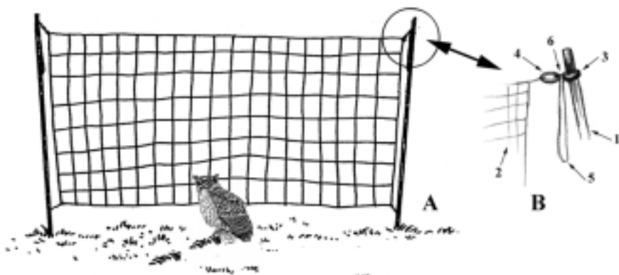
Рис. 29. Опадная сеть и ее крепежный механизм: 1 - кольшечек, 2 - сеть, 3-4 - крепежные кольца, 5 - шнур, связывающий крепежные кольца, 6 - сторожевая перемычка из резинки.
