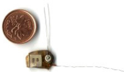
Рис. 24. Радиопередатчик для крепления на хвосте птицы, изготовленный компанией «Global Tracking Systems Inc.».
