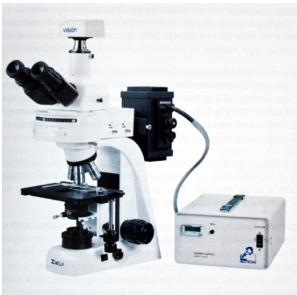
Рис. 11. Флуоресцентный микроскоп с цифровой камерой
