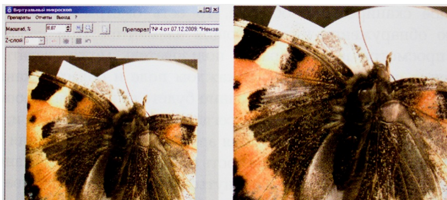
Рис. 29. Программа Vision Slide захватывает соседние поля (слева), обработанное и «склеенное» изображение (справа)
