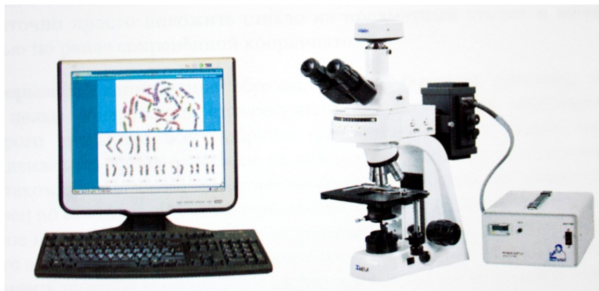
Рис. 27. Комплекс для хромосомного и FISH анализа на базе по KarvoFISH (Vision, Австрия) и микроскопа MT6300 (Meiji Techno, Япония)
