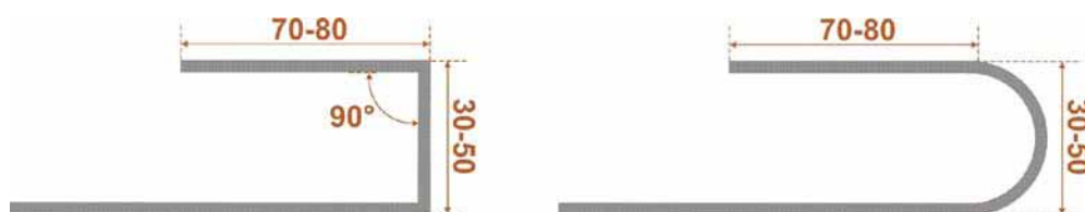
Рисунок 21. Схема закінчення охоронно-направляючої огорожі для земноводних
