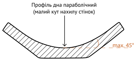
Рисунок 39. Поперечний переріз лотка «словацького» типу, що використовується на залізничних лініях
