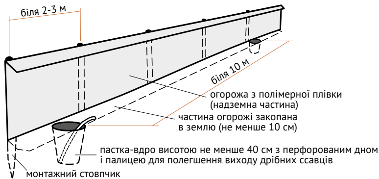
Рисунок 22. Схема тимчасової захисної огорожі (на основі MAmS, переглянута)
