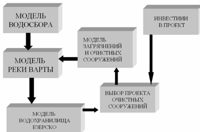
Рис. 2.5.2.2. Общая блок-схема модели управления качеством воды в реке Варта
