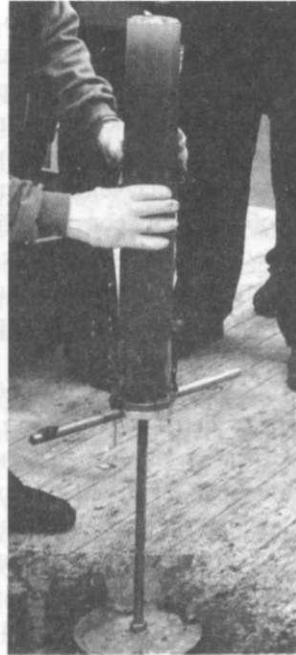
Рис. 2-7. Трубка мультикорера на штативе.
