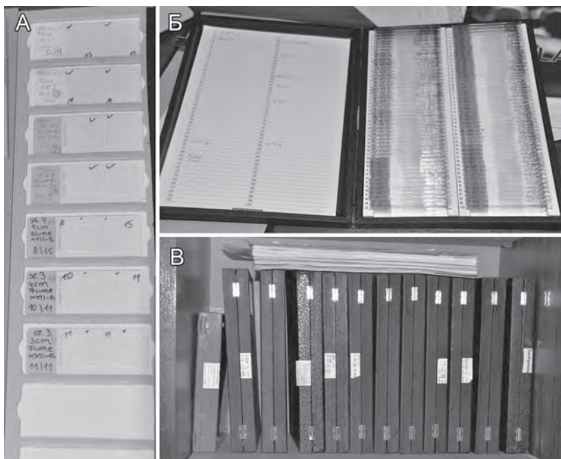
Рис. 66. Хранение препаратов: А — картонный планшет, Б — пластиковая коробка для препаратов, В — правильное хранение коробок с глицериновыми препаратами в вертикальном положении.
