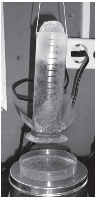
Рис. 59. Выделение мейобентоса методом Улига в полевой лаборатории. Цилиндр, сделанный из 100-мл шприца, закрыт снизу крупным газом и до половины заполнен песком. Сверху лежит морской лёд. Талая вода стекает в расчерченную на квадраты чашку Петри.
