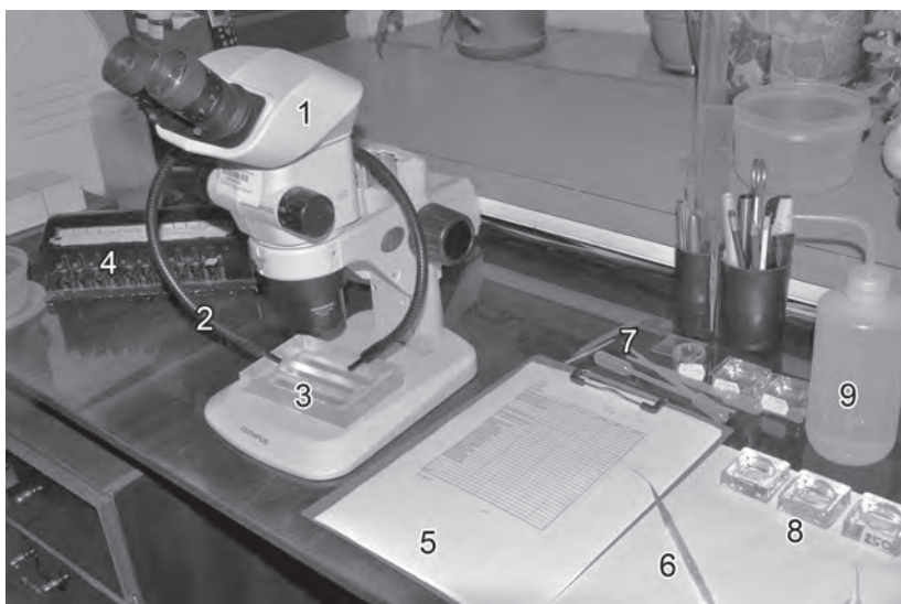
Рис. 62. Рабочее место для разбора мейобентосных проб: 1 — бинокляр, 2 — осветитель, 3 — камера Богорова, 4 — счётчик форменных элементов крови, 5 — протокол разборки, 6 — самодельная препаровальная игла из акупунктурной иголки и пипеточных носов, 7 — пластиковые пипетки, 8 — солонки, 9 — бутылка-промывалка с фильтрованной морской водой.
