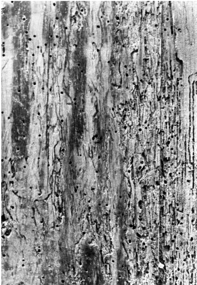
Рис. 14. Задняя стенка напольных часов (фрагмент) поврежденная под обоями грабовым и мебельным точильщиками (Костромская обл.).
