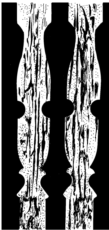
Рис. 43. Ножи рояля (продольный разрез), источенные рыжим усачом (по Воронцову).
