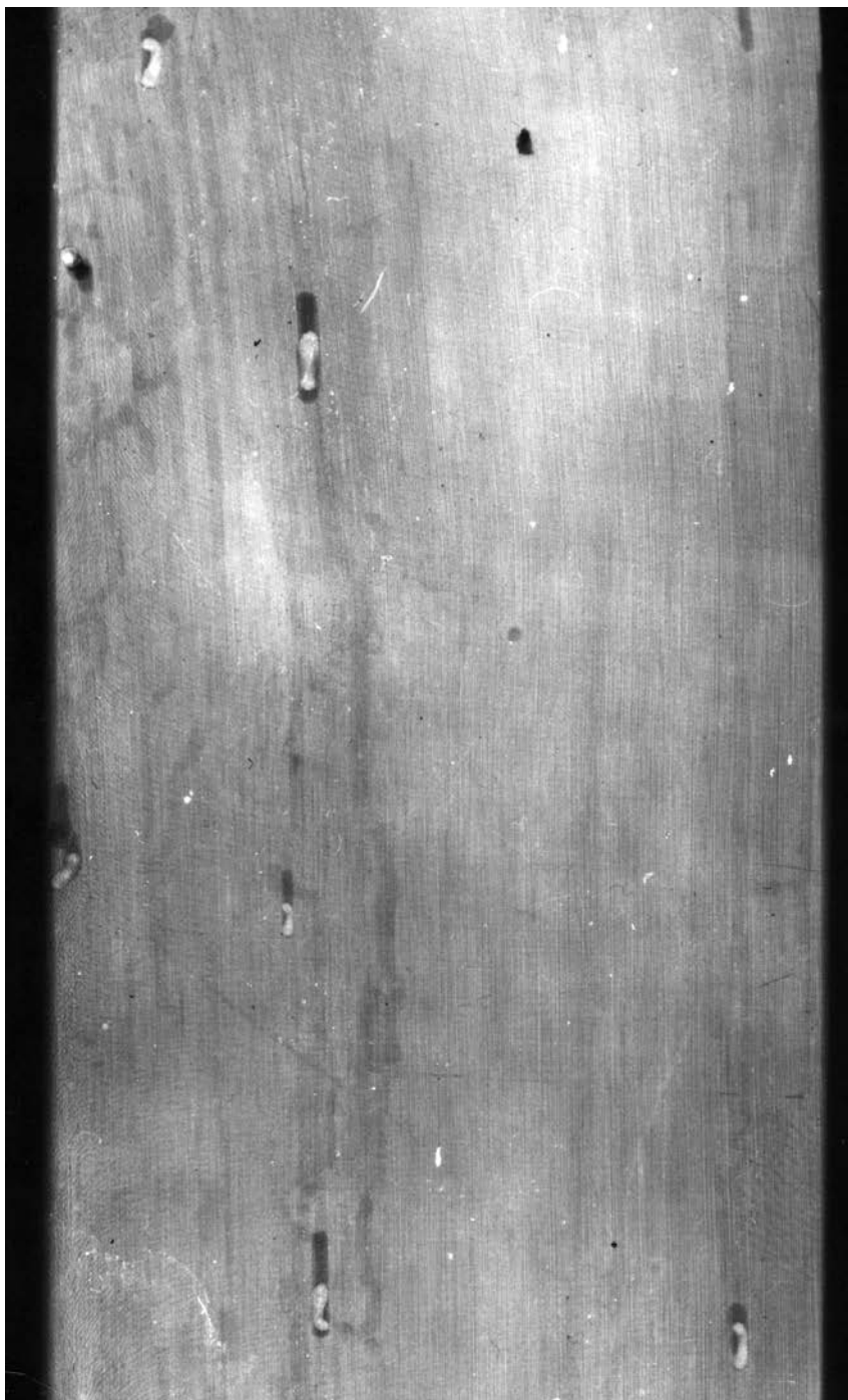
Рис. 68. Рентгенограмма фанерной дощечки с личинками мебельного точильщика.
