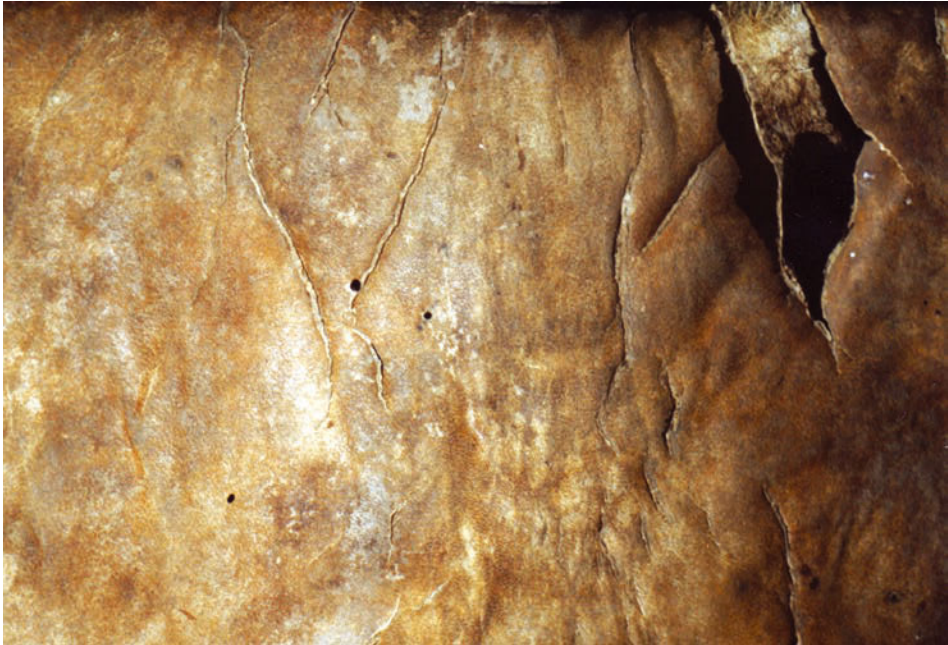
Рис. 75. Цигейка, поврежденная платяной молью – мех полностью уничтожен, видны сквозные отверстия в кожаной основе.
