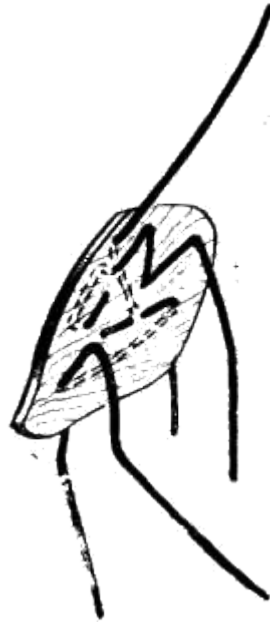
Рис. 49. Крепление проволок в деревянном профиле
