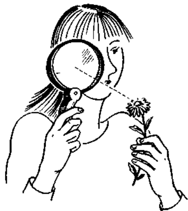
Рис 9. Правило пользования лупой (объект анализа располагается в фокусе)
