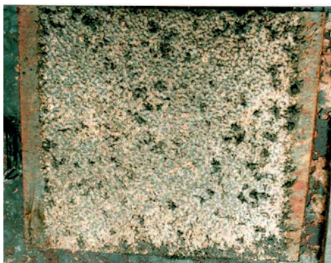
Рис. 75. Пластина из асбоцемента при 15-суточной экспозиции в бух. Золотой Рог, июль 2001 г.
