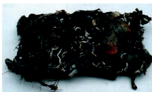
Рис. 55. Пластина из высоколегированной стали при экспонировании в бух. Рында с июня по октябрь 2000 г.
