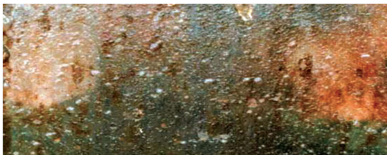
Рис. 69. Вид экспериментальной пластины из оргстекла, экспонируемой в бух. Рында (с 11.09 по 04.10. 2000 г.).
