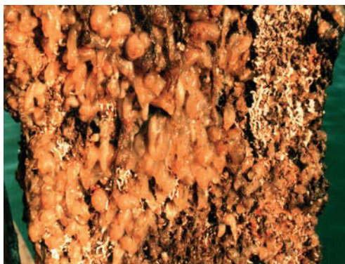
Рис. 77. Пластина из асбоцемента при 3-х месячной экспозиции в бух. Золотой Рог, август 2001 г.
