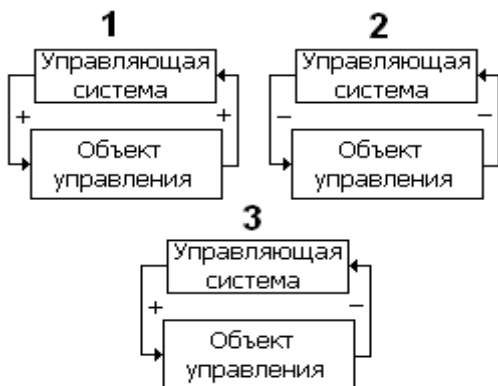
Рис. 1.6. Типы обратных связей: 1 – положительная обратная связь с взаимным усилением (знаком «+» обозначено усиление воздействия), 2 – положительная обратная связь с взаимным ослаблением (знаком «-» обозначено ослабление воздействия), 3 – отрицательная обратная связь (по Федорову, 2000)
