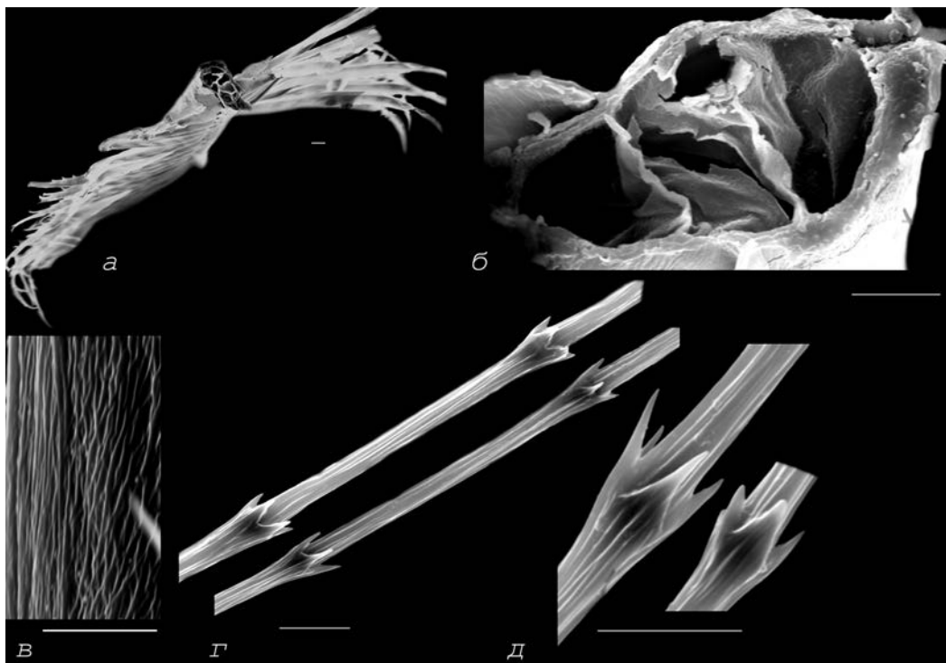
Эл. 23. Белокрылая крачка Chlidonias leucopterus (Laridae). Покровное перо. Бородка I контурной части опахала: а – поперечник; б – сердцевина на поперечном срезе; в – рельеф кутикулы; г, д – бородки II пуховой части опахала. Масштабная линейка 10 мкм.
