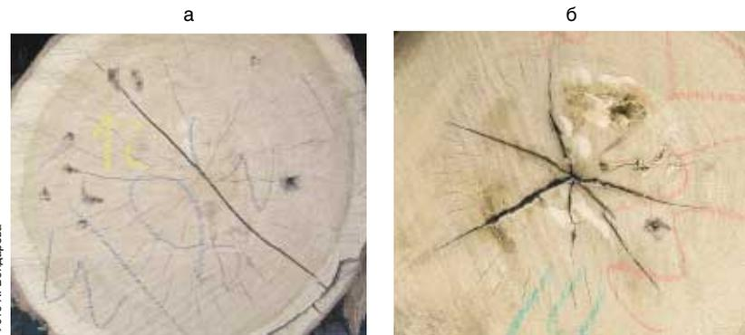
Рис. 10. Метиковые трещины: а — простая; б — сложная
