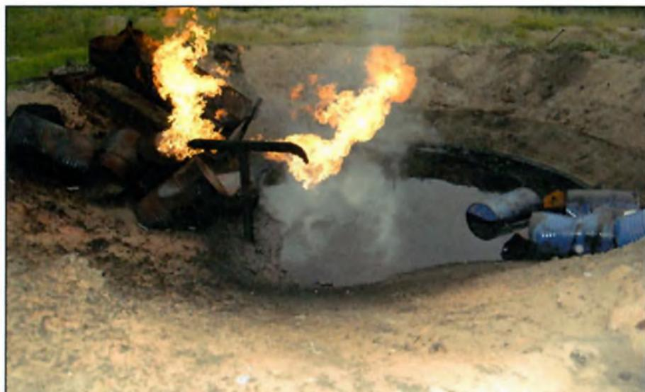
Рис. 6. Усинское месторождение, 2008 г. Наземная факельная горелка. Фото М.Д. Туманова
