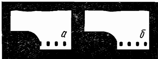
Рис. 24. Подрезка концов пленки: а — неправильно, б — правильно
