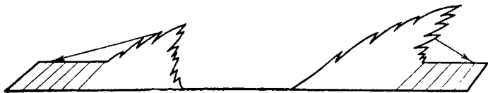
Рис. 4. Наклон пламени при ветре на фронте и в тылу пожара. Заштрихован подготовляемый к горению покров
